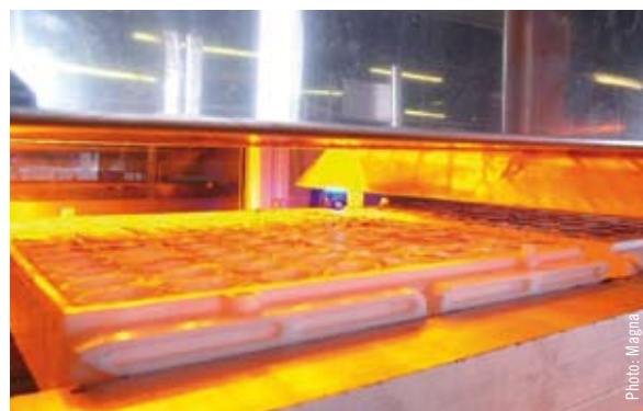
Préchauffage des moules avant remplissage
